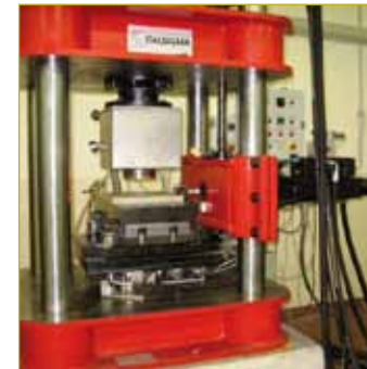
2. Custom servohydraulic testing machine (Politecnico di Milano)
