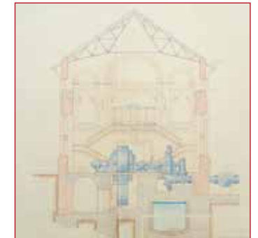
2. Centrale di Fraele. Cross section on the turbine hall (Archivio A2A, Grosio)
